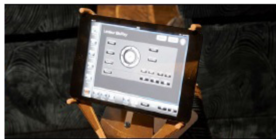
L'interface Crestron sur l'iPad mini permet de gérer la lumière et les différentes sources.
